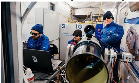
Как отметили в «Росатоме», удаление деревьев и кустарника в труднодоступной местности с проходящими ЛЭП с помощью тяжелой спецтехники занимает много времени — до нескольких недель, а лазерная резка, отечественную технологию которой разработали в ТРИНИТИ, сокращает сроки расчистки
