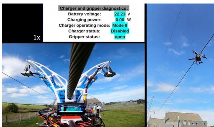
Помимо литий-полимерного аккумулятора емкостью 7000 мА·ч дрон оснащен микрокомпьютером Raspberry Pi 4 В, модулем автопилота Pixhawk V6X, радаром миллиметрового диапазона и видеочамерой RGB.
